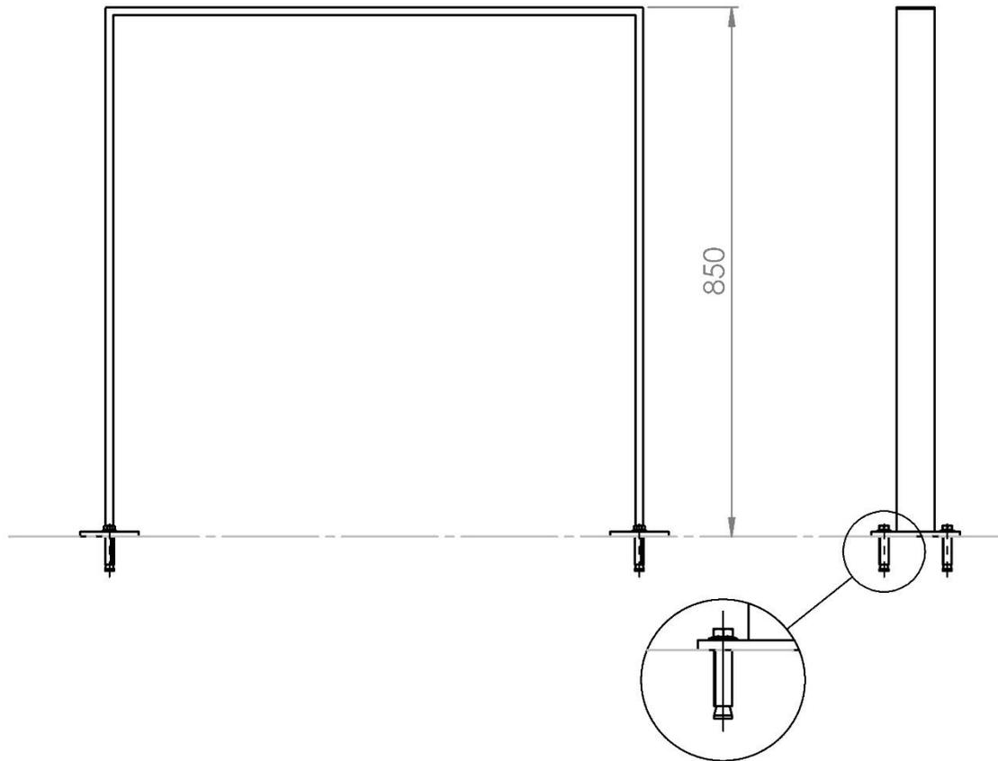
Die Fundamente sind abhängig von den örtlichen Gegebenheiten / Bodenaufbau. Dies ist ein Vorschlag ohne Gewähr.
